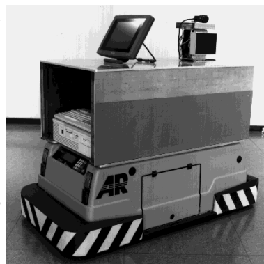
Abbildung 2: Mobiler Roboter ATHENE II ; LBH: 135 cm x 70 cm x 110 cm
