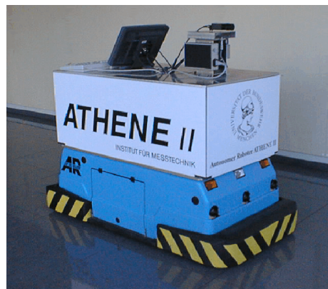
Abbildung 2: ATHENE II , ein intelligenter mobiler Roboter, basierend auf einem konventionellen Flurförderfahrzeug und ausgestattet mit einem objektorientiertem Sichtsystem
