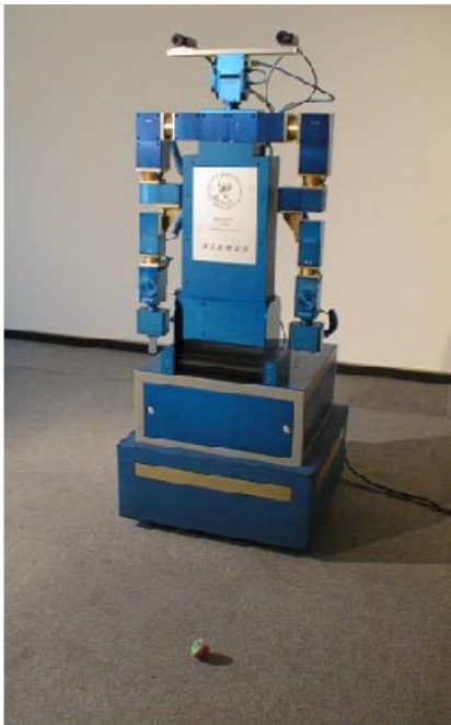
Bild 2: HERMES ist ein vielseitig einsetzbarer, modular aufgebauter, mobiler Roboter mit einer dem Menschen vergleichbaren Anordnung seiner „Arme“ und „Augen“. Zwei an einem nach vorne und hinten abknickbaren Oberkörper befestigte Arme führen zu einer erheblichen Erweiterung des Arbeitsraums, der durch das auf einer frei beweglichen Sensorplatte
